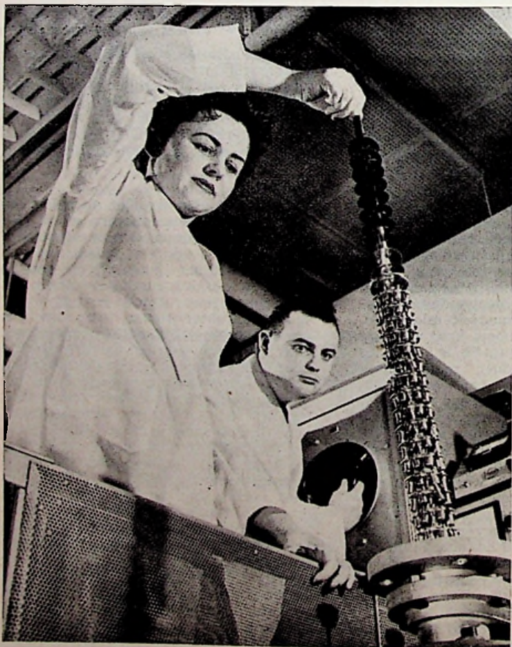
Deze „Shish-Kebab”, met ongeveer honderd Nuvistors, wordt voor een laatste behandeling in een vacuüm installatie gebracht.
